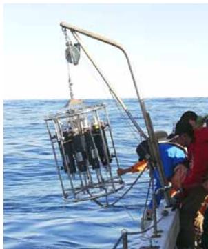
豊旗丸からのCTDマルチ・ウォーター・サンブローによる海洋観測の様子
