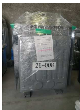
保管中の微量混入トランス(朝倉)
