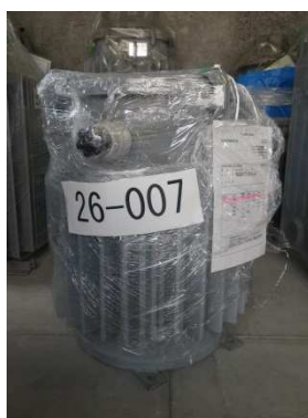
保管中の微量混入トランス(朝倉)
