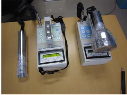
Fig. 1. 空間線量測定に用いられたガンマ線測定器(福島大学)
