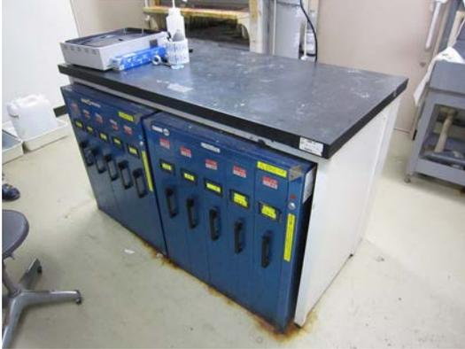
Fig. 2. 東北大学における薬品庫の安全対策. キャビネットは固定せず, 実験台で落下物から保護する対策を講じている (固定すると薬品の入ったガラス瓶が破損するリスクが高まる).
