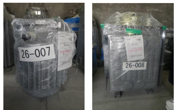
保管中の微量混入トランス（朝倉）
